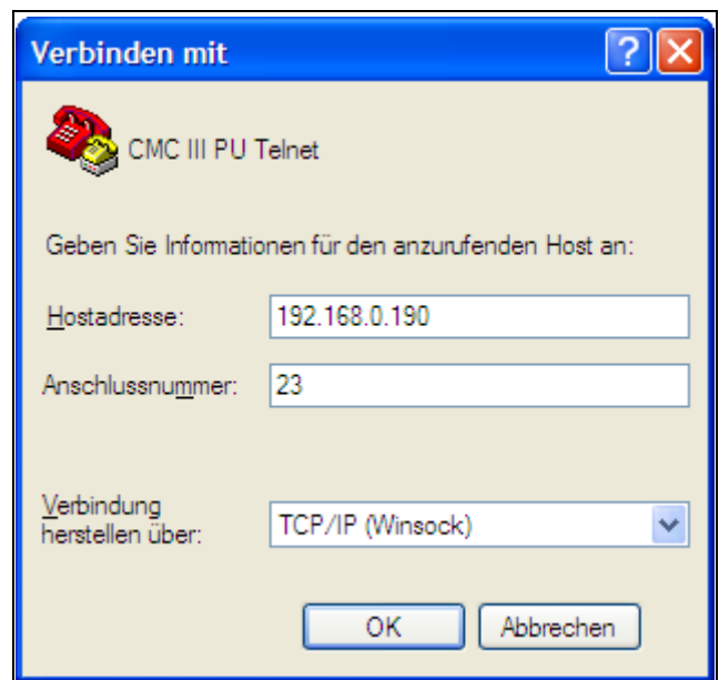
Abb. 15: Verbindungseinstellung „CMC III PU Telnet“
