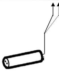
Der Luftstrom Sensor wird je nach Einstellung der Empfindlichkeit und Bauart des Lüfters in den Luftstrom positioniert. Bei Unterschreitung des Grenzwertes wird ein Alarm ausgelöst. Bei der Climate Unit kann in Verbindung mit einem Temperatur Sensor auch der Regelkreis in die Überwachung integriert werden. Das bedeutet, beim geregelten Stop des Lüfters wird kein Alarm ausgelöst.
